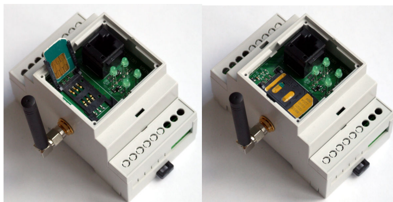
Рис. 3. Пример установки SIM карты
